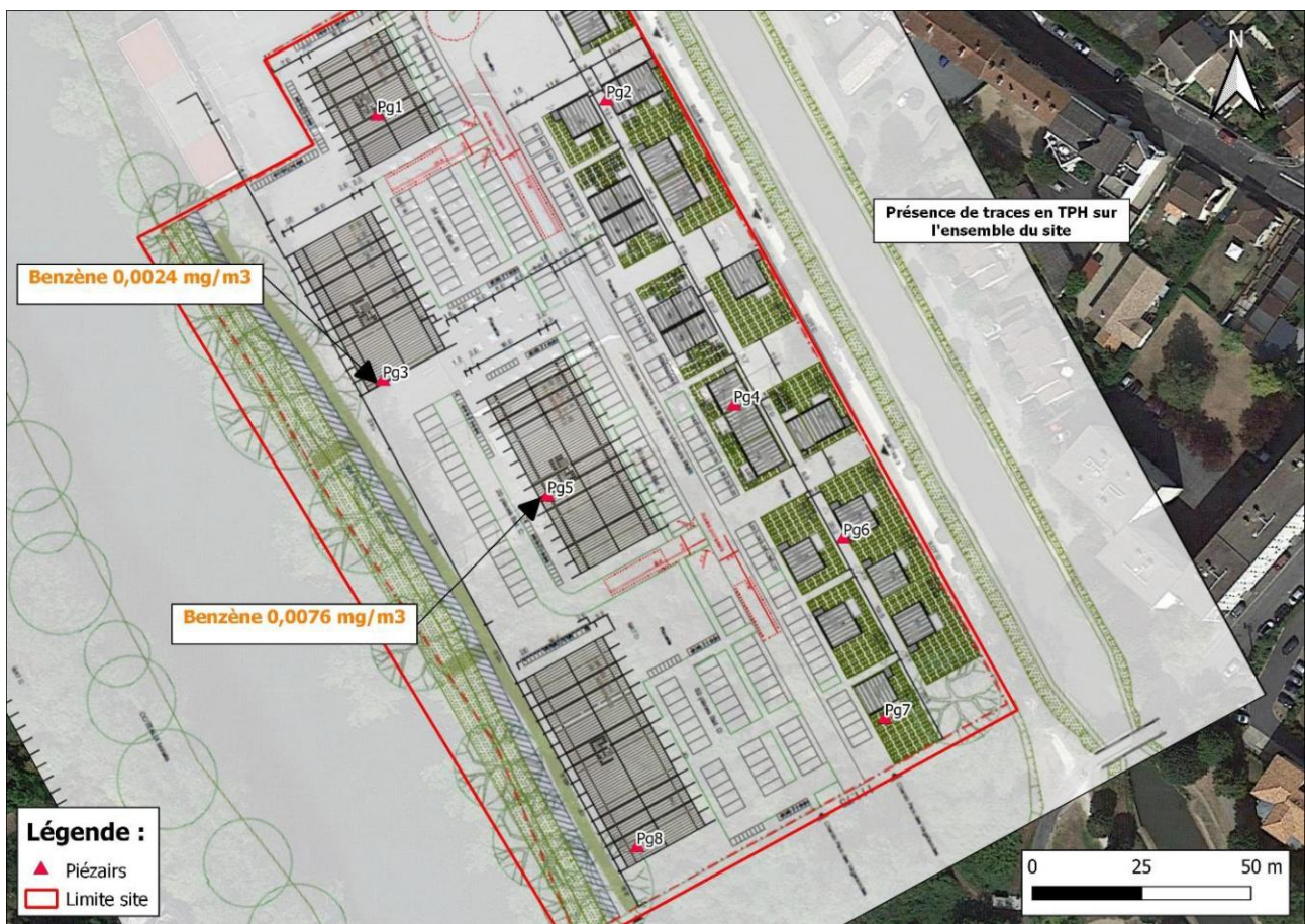
Figure 8 : Localisation des piézairs et synthèse des impacts dans les gaz des sols
