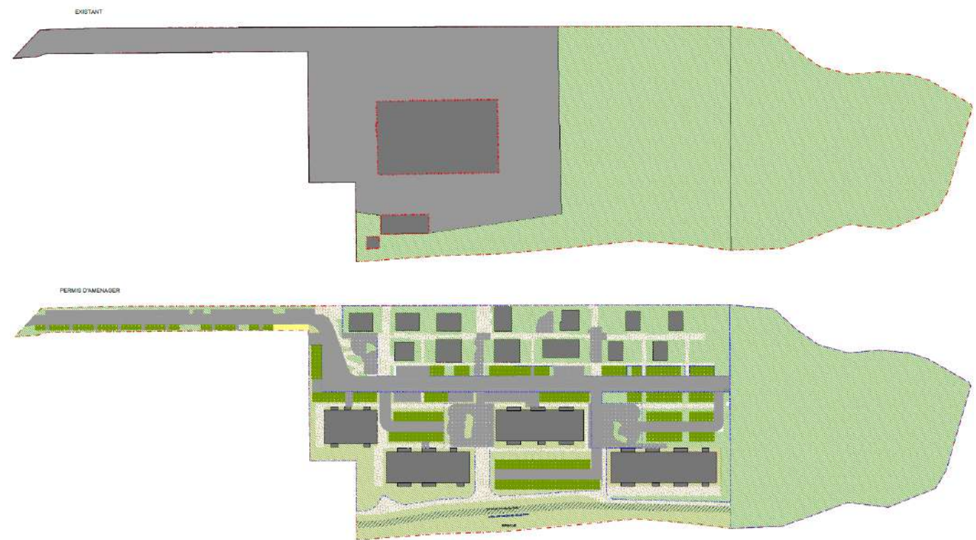
Figure 176 : Cartes des surfaces imperméabilisées à l'état initial (en haut) et avec le projet (en dessous) (Source : SL ARCHITECTURE)
