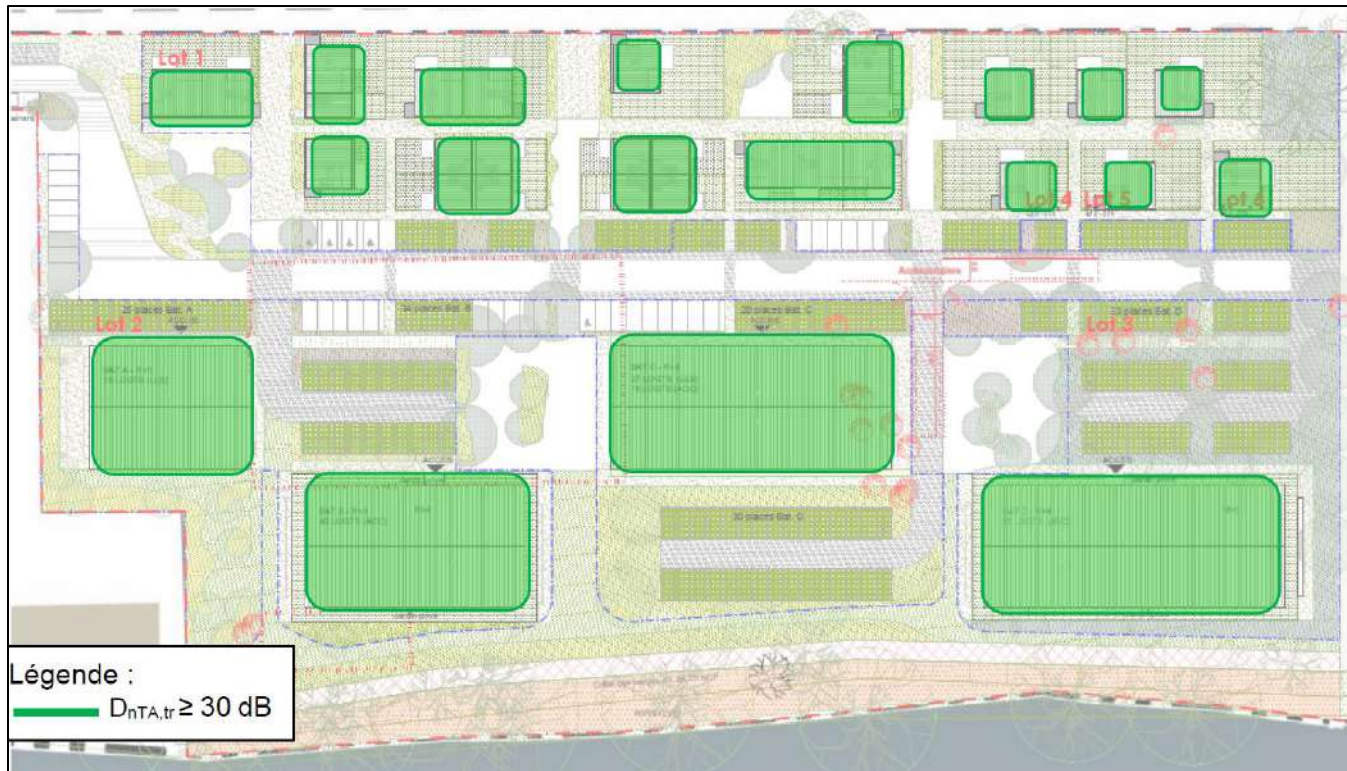
Figure 160 : Représentation de l'isolement de chacun des façades des bâtiments (Source POLYEXPERT ENVIRONNEMENT - 2022)
